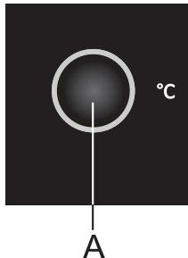
Если дверца прибора открыта больше двух минут, включается непрерывный звуковой сигнал. Чтобы выключить звуковой сигнал, закройте дверцу или нажмите кнопку **A**.
