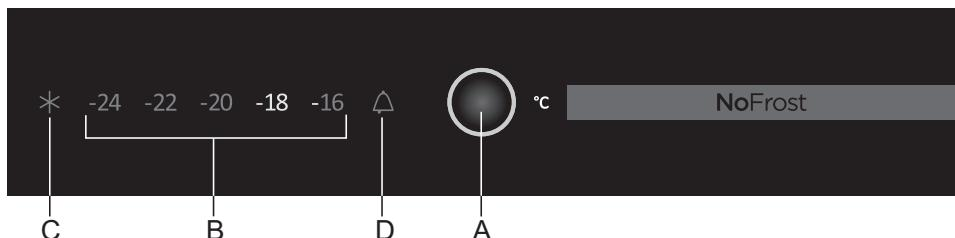
А Кнопка установки температуры и включения «Быстрого замораживания»
