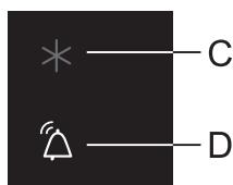
При первом включении прибора и при превышении допустимой температуры в холодильном отделении (выше +13°C) включается прерывистый звуковой сигнал и мигает индикатор **D**.
