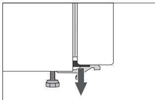
На углах дверей установлены распорки. Снимите распорки и на их место вставьте заглушки, которые прилагаются в комплекте (в некоторых моделях).
