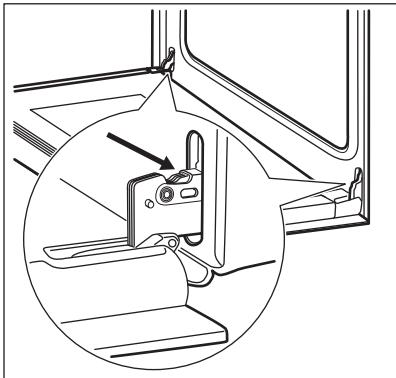
2. Поднимите и поверните рычажки, расположенные в обеих петлях.
