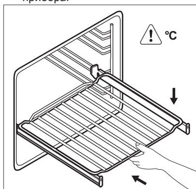
Обязательно полностью задвиньте телескопические направляющие внутрь прибора перед тем, как закрыть дверцу духового шкафа.
