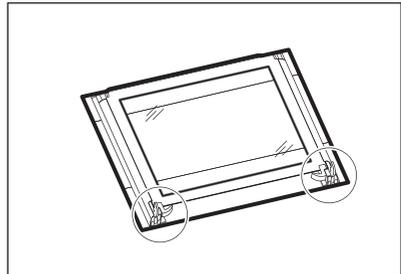
5. Отожмите стопоры, чтобы снять внутреннюю стеклянную панель.
