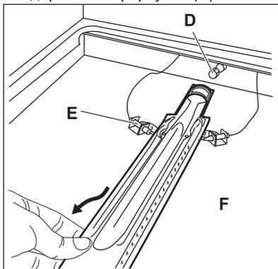
4. Плавно переместите ее влево. Не прилагайте усилия к проводу, идущему к разъему свечи зажигания (F) и к проводу термопары (E).
