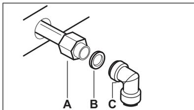
**A)** Труба подачи газа, вывод трубы подачи газа с гайкой
