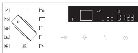
**3** Через некоторое время после начала пиролизной очистки для обеспечения безопасности дверца духовки автоматически заблокируется. На дисплее загорится символ «ключ».
