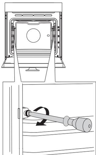
**1** Открутите винт с помощью отвертки.
