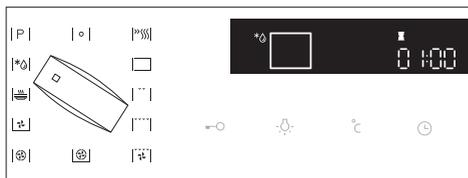
Установите переключатель РЕЖИМА НАГРЕВА в положение «Размораживание».
