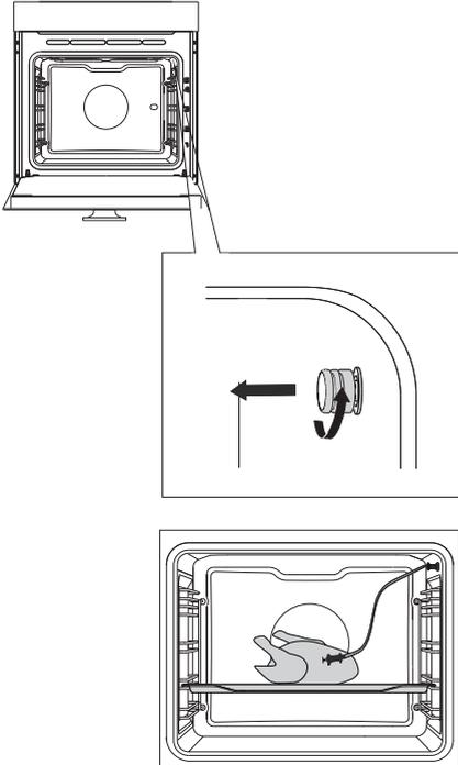
**1** Выньте металлическую заглушку (гнездо для зонда расположено в переднем верхнем углу на правой стенке духовки).
