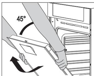
**3** Медленно закрывайте дверцу до угла 45° (относительно закрытого положения дверцы), затем приподнимите ее и аккуратно снимите.
