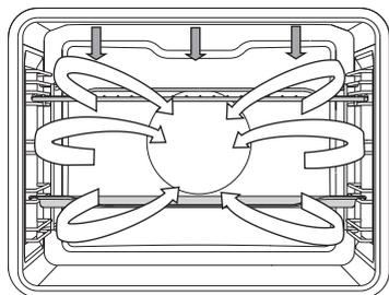
Одновременно работают верхний нагревательный элемент, инфранигреватель и вентилятор. Предназначен для приготовления мяса, рыбы, овощей.
