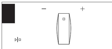
**1** Поверните ПЕРЕКЛЮЧАТЕЛЬ ИЗМЕНЕНИЯ/ ВЫБОРА НАСТРОЕК (-/+ ) и сначала установите минуты, затем часы. Через три секунды установленное время сохранится.
