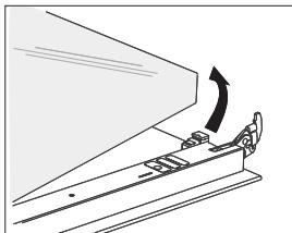
**2** Возмите стекло дверцы за нижний край, немного приподнимите, чтобы оно освободилось из фиксаторов, и снимите.
