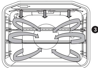
Одновременно работают верхний нагревательный элемент, инфранагреватель и нагревательный элемент вокруг вентилятора. Используется для приготовления всех видов мяса.
