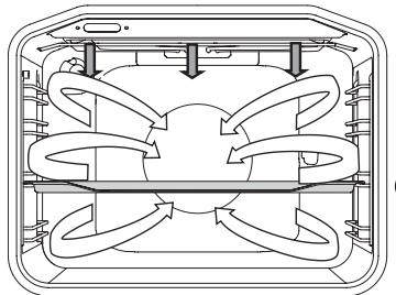
Одновременно работают верхний нагревательный элемент, инфранагреватель и вентилятор.
