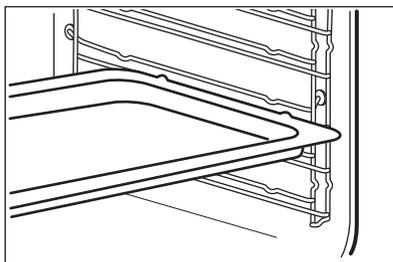
Одновременная установка решетки и глубокого противня:
