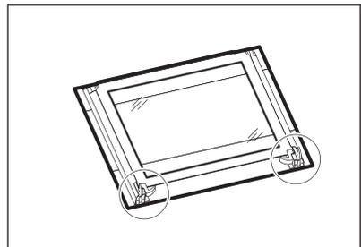
8. Отожмите стопоры, чтобы снять стеклянные панели.
