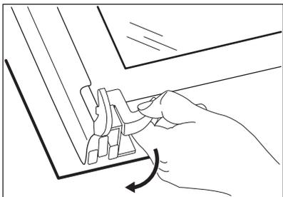
9. Поверните два фиксатора на 90° и извлеките их из своих гнезд.
