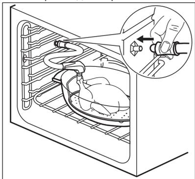
2. Поместите емкость на решетку, установленную на первой или второй полке снизу. Убедитесь, что трубка форсунки не пережата и не касается нагревательного элемента в верхней части духового шкафа.
