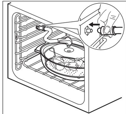
Убедитесь, что трубка форсунки не передавлена и не касается нагревательного элемента в верхней части духового шкафа.
