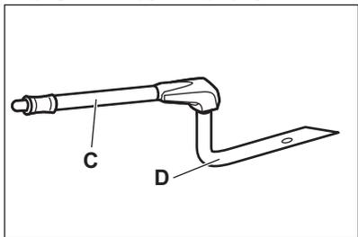
«С» – форсунка с трубкой для приготовления на пару; «D» – форсунка для приготовления непосредственно на пару.
