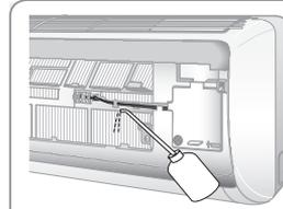
После завершения установки сливного шланга, налейте воду в дренажный поддон, чтобы проверить, хорошо ли дренирует шланг.
