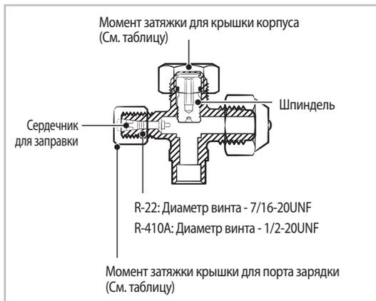
**Чтобы проверить отсутствие утечек газа на наружном блоке,** Проверьте вентили А и В с помощью детектора утечки.
