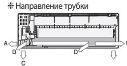
1. Определите положение отверстия для трубки и сливного шланга как показано на рисунке, и просверлите отверстие внутренним диаметром 65 мм так, чтобы оно слегка наклонилось вниз.
