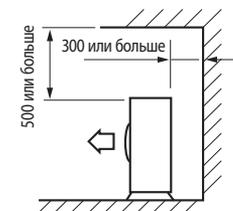
◆ Если стены блокируют переднюю и заднюю стороны наружного блока
