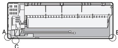
1. Вырежьте подходящую продавленную часть (A или B) на задней панели внутреннего блока, если вы подключаете эту трубку непосредственно с тыльной стороны.
