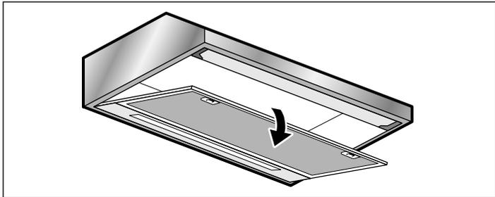
3. Установите решётку фильтра под наклоном и снимите её.
