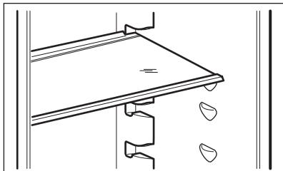
Расположенные на стенах холодильника направляющие позволяют размещать полки на нужной высоте.
