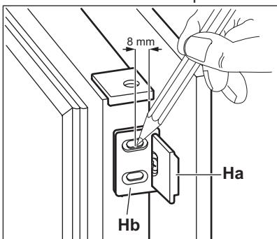
22. Снимите кронштейны и отметьте расстояние 8 мм от внешнего края дверцы: это место для гвоздя (К).
