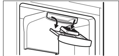
Для обеспечения оптимальной работы угольного воздушного фильтра, его следует ежегодно заменять.
