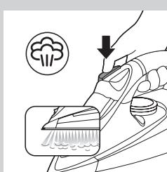
Паровой удар помогает разгладить стойкие складки. Функция "Паровой удар" равномерно распределяет проникновение пара в каждую складку одежды.
