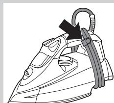
**4** Намотайте шнур питания на приспособление для хранения шнура и закрепите его зажимом для шнура.
