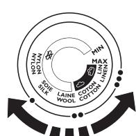
**1** Для установки необходимой температуры глажения поверните дисковый регулятор нагрева в необходимое положение (см. расположенную выше таблицу “Температурный режим и режим подачи пара”).
