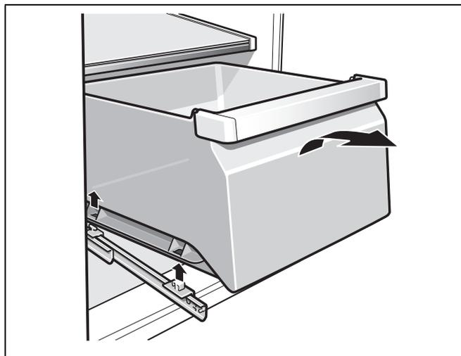
Чтобы вставить бокс на место, установите его на направляющих и задвиньте вовнутрь. Зафиксируйте бокс нажатием вниз.
