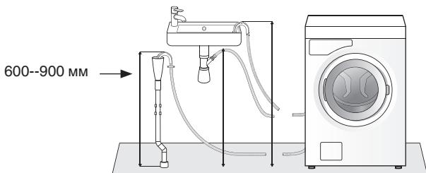
Машина также может быть подключена к стоку с помощью втулочного соединения (сифона). В таком случае шланг также должен находиться на высоте 600-900 мм над уровнем пола. Внутренний диаметр отверстия должен составлять не менее 18 мм.
