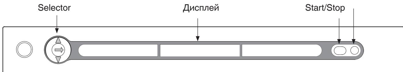
Программу можно выбирать, вращая переключатель программ. На дисплее подсвечивается название выбранной программы и отображается время завершения ее выполнения.
