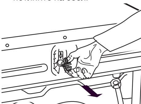
3. Снимите пластмассовые заглушки с пробок. Вставьте их в отверстия, где находились пробки. Сохраните пластмассовые пробки на случай транспортировки машины в будущем.
