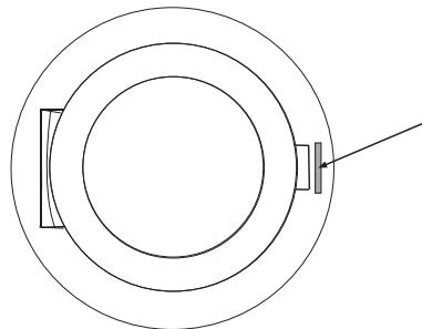
После использования установите шпатель для принудительного открывания дверцы C на место B (см. рис. в разделе «Дозатор»).
