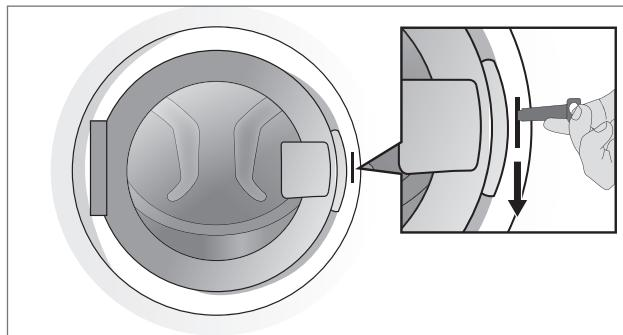
После использования установите шпатель для принудительного открывания дверцы C на место B (см. рис. в разделе «Дозатор»).
