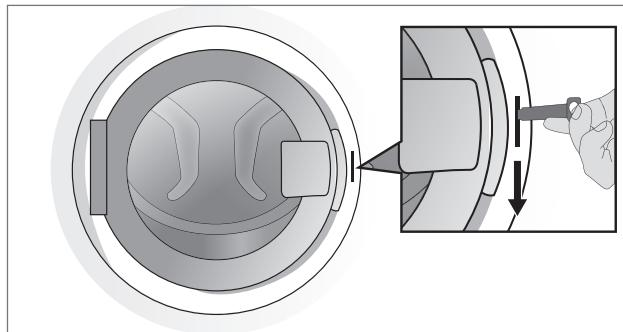
После использования установите шпатель для принудительного открывания дверцы C на место B (см. рис. в разделе «Дозатор»).
