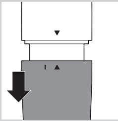
**2** Снимите крышку отсека для батареи с ручки.
