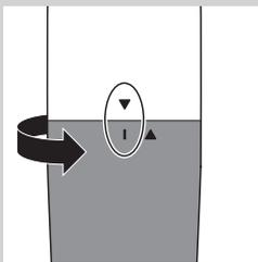
**5** Поверните крышку отсека для батареи против часовой стрелки так, чтобы она оказалась в положении "закрыто".
