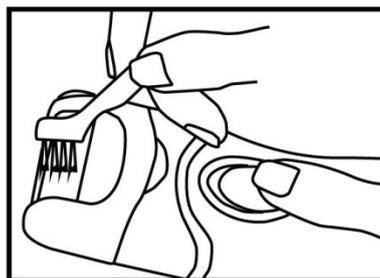
Для тщательной очистки рекомендуется снять шлифовальный ролик и вычистить щёткой сам ролик и место его установки.
