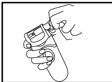
3. Вставьте новый шлифовальный ролик на место прежнего. Во время установки должен раздаться щелчок, свидетельствующий о том, что ролик зафиксирован надежно.
