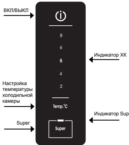
**ВКЛ/ВЫКЛ** - нажатием данной кнопки можно включить весь прибор в целом (как холодильную, так и морозильную камеры). Для отключения холодильника достаточно нажать кнопку.
