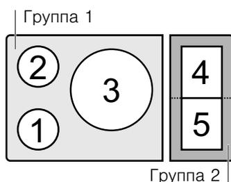
**Указание:** Для получения максимальной мощности на конфорке с изменяемой площадью нагрева установите один предмет посуды в центр конфорки так, как это описано в разделе «Конфорка с изменяемой площадью нагрева».
