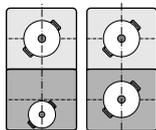
Передняя и задняя конфорки с двумя индукторами в каждой могут использоваться независимо, так что уровень мощности задается для каждой из них отдельно. В этом случае рекомендуется использовать только один предмет посуды в каждой зоне.
