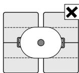
Если варочная панель имеет более одной конфорки с изменяемой площадью нагрева, не рекомендуется использовать для нагрева одной кастрюли или сковороды несколько таких конфорок одновременно.
