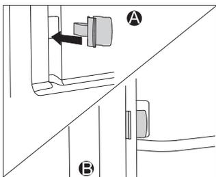
При установке полностью выдвигающихся телескопических направляющих с вкладышами EasyClean установите фиксаторы (прилагаются в комплекте) в отверстия в нижней части боковых стенок духовки. Защелкните направляющие в фиксаторах.
