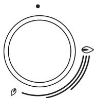
Мощность нагрева обозначена на переключателях символами «Большое пламя» и «Малое пламя». Вращайте переключатель через положение «Большое пламя» (☹) до положения «Малое пламя» (☺) и обратно. Рабочее положение находится между символами «Большое пламя» и «Малое пламя». Не рекомендуется устанавливать мощность между (☹) и (●). В данном диапазоне пламя нестабильно и может погаснуть.
