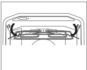
После очистки задвиньте верхние нагревательные элементы обратно, пока держатель не зафиксируется в углублениях.
