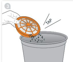
Удалите пыль из фильтра, постукая им по твердой поверхности. Не мойте фильтр.
