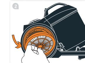
После снятия крышки фильтра вы легко сможете извлечь постмоторный HEPA фильтр.
