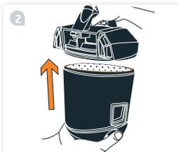
Поднимите крышку для доступа к предмоторному фильтру.
