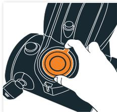
Поворотом ручки регулирования мощности отрегулируйте мощность всасывания пылесоса в соответствии с типом поверхности.
