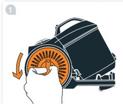
Постмоторный HEPA фильтр располагается в левом колесе. Удерживайте центр колеса и поверните крышку фильтра против часовой стрелки.
