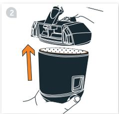
Поднимите крышку для доступа к предмоторному фильтру.
