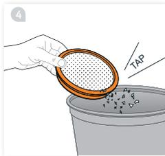
Постукиванием удалите пыль из фильтра. Проймите под проточной водой и дайте высохнуть в течение 24 часов.
