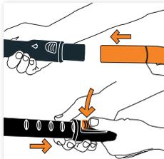
Соедините металлическую трубу с ручкой шланга. Все насадки могут быть установлены на конце металлической трубы или на шланге.
