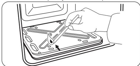
3. Одновременно нажмите на ручку выбора режимов духового шкафа и поверните ее против часовой стрелки в положение, соответствующее максимальной подаче газа.
