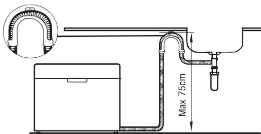
Сливной шланг подсоединяется к сливной водопроводной трубе диаметром не менее 4 см либо выводится в кухонную мойку. Следите, чтобы шланг не сгибался и не перекручивался. Используйте специальное опорное колено (кронштейн) из комплекта поставки. Свободный конец шланга должен располагаться на высоте не более 75 см, и не должен быть погружен в воду.
