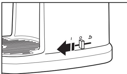
**4** Передвиньте пусковой рычаг на **I**.
