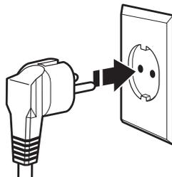
**1** Вставьте штепсель эспрессо-машины в заземленную розетку.
