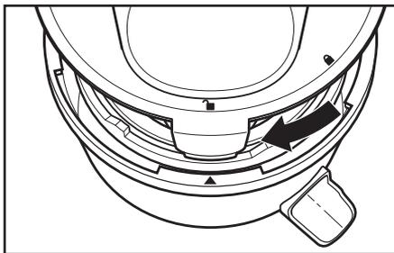
**6** Поставьте крышку на соковыжималку таким образом, чтобы значок на крышке совпал с красной стрелочкой на чаше. Поверните крышку по часовой стрелке до щелчка.
