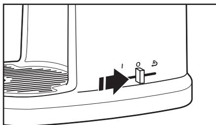
**6** На стенках фильтра и узле шнека может накапливаться мякоть, вызывая заклинивание. Уберите излишки мякоти, передвинув пусковой рычаг на **O** и затем на **R**.
