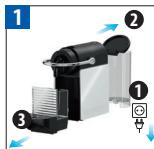
Odlacz maszynę od sieci, zdejmij zbiornik na wodę i wyjmij pojemniki z maszyny.
