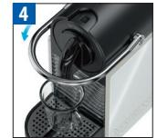
Opuścić dźwignię i umieścić filiżankę pod otworem wylotu kawy.
