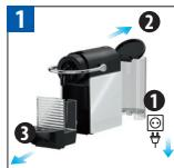
Odłącz maszynę od sieci, zdejmij zbiornik na wodę i wyjmij pojemniki z maszyny.
