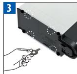
Do odłączenia paneli użyj specjalnego klucza Nespresso w czterech otworach w podstawie.
