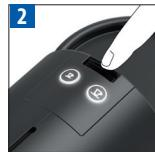
Włączyć urządzenie. Pulsujące diody: nagrzewanie przez około 25 sekund. Światło stałe: gotowe.
