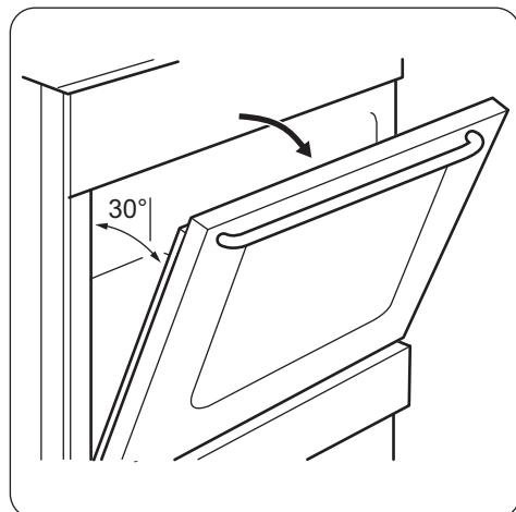
2. Возьмитесь за дверную планку (B) на верхней кромке дверцы с обеих сторон и нажмите внутрь, чтобы освободить защелку.
