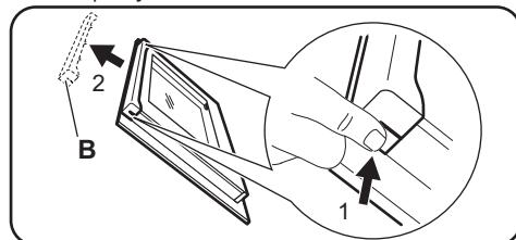
3. Чтобы снять дверную планку, потяните ее вперед.
