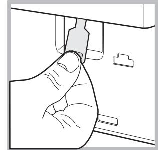
3. снимите переднюю панель стиральной машины при помощи отвертки (см. схему).
