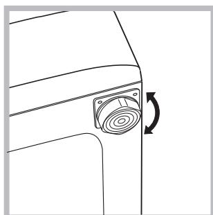
ослабьте контргайку, после завершения регулировки контргайку затяните.
