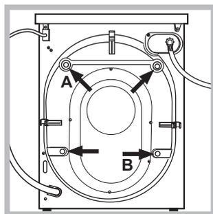
3. Снимите 4 винта, предохраняющие машину в процессе перевозки, и резиновые пробки с соответствующим распорными шайбами, расположенные в задней части стиральной машины (см. рис.).
