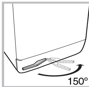
Ваша стиральная машина может быть оснащена специальными убирающимися колесами для облегчения ее перемещения. Чтобы опустить колеса и передвинуть оборудование, просто потяните за рычаг, расположенный слева под основанием машины. После установки оборудования в требуемое положение верните рычаг в исходное поло.
