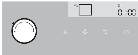
Установите переключатель РЕЖИМА НАГРЕВА в положение «Размораживание».
