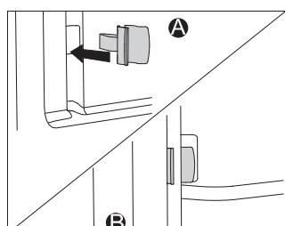
При установке полностью выдвигающихся телескопических направляющих с вкладышами EasyClean установите фиксаторы (прилагаются в комплекте) в отверстия в нижней части боковых стенок духовки. Защелкните направляющие в фиксаторах.
