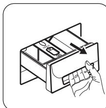
Потяните дозатор моющих средств на себя до упора. Положение **A** перегородки для моющих средств предназначено для порошкового моющего средства.
