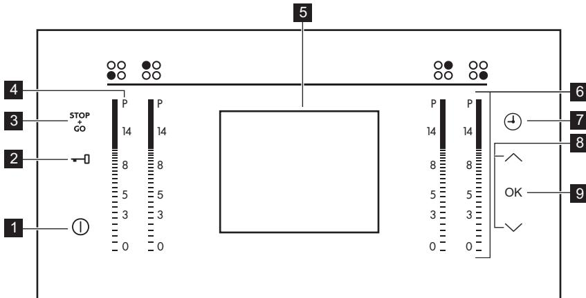
Управление прибором осуществляется с помощью сенсорных полей. Работа функций подтверждается выводом информации на дисплей, а также визуальной и звуковой индикаций.
