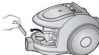
Извлеките фильтр защиты двигателя из пылесоса. Вытряхните пыль из фильтра и установите его назад в пылесос.
