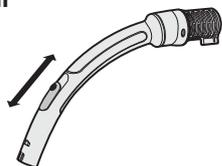
Чтобы снизить мощность всасывания для чистки штор, ковриков и других легких тканей, потяните заглушку до тех пор, пока не откроется отверстие.
