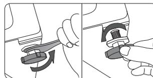
3. Когда стиральная машина будет выровнена, затяните гайки с помощью гаечного ключа.
