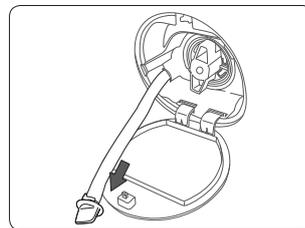
4. Держа конец сливной трубки, откройте ее крышку.
