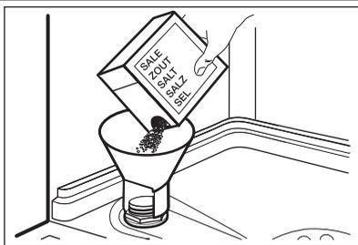
1. Поверните крышку против часовой стрелки и откройте емкость для соли.
