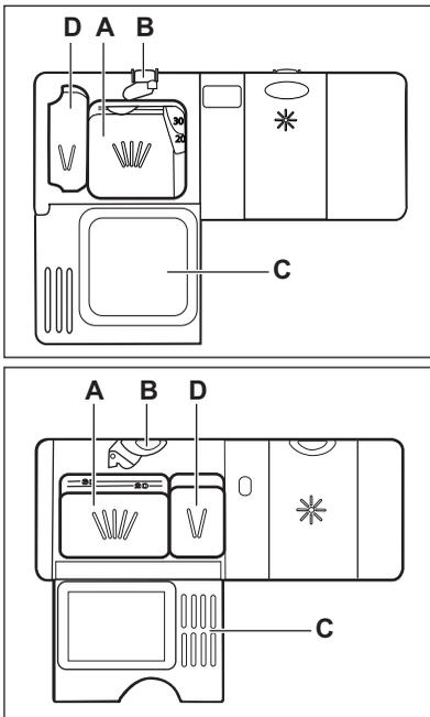
1. Нажмите на кнопку снятия блокировки (B), чтобы открыть крышку (C).
