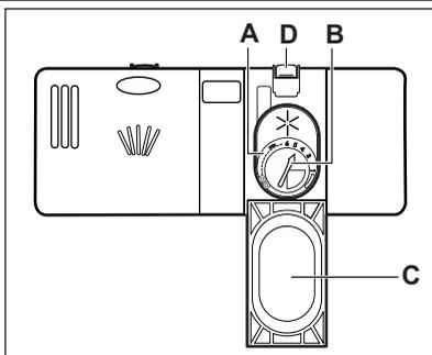
1. Нажмите на кнопку снятия блокировки (D), чтобы открыть крышку (C).
