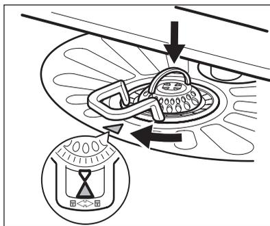
1. Поверните фильтр (A) против часовой стрелки и извлеките его.
