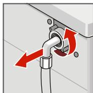
Снимите шланг со спинки прибора.
