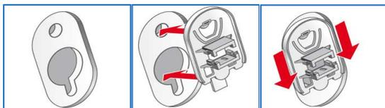
**i** Зафиксируйте заглушки нажатием на стопорные крючки.
