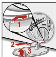
7. Вставьте сервисную крышку (1), зафиксируйте ее в пазе (2) и закройте (3).
