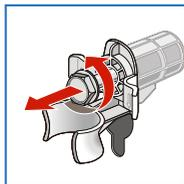
3. Отвинтите и снимите все 4 транспортировочных фиксирующих винта.
