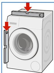
2. Проверьте положение стиральной машины с помощью уровня, при необходимости откорректируйте. Путем вращения ножек измените высоту.
