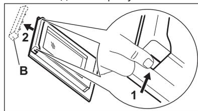
7. Чтобы снять дверную планку, потяните ее вперед.
