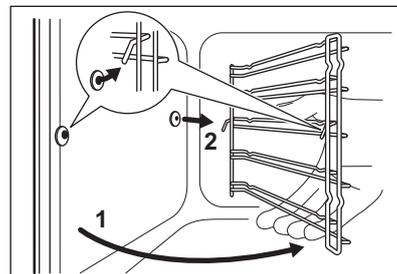
Установка направляющих для противня производится в обратном порядке.
