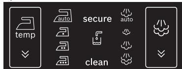
2. Затем прибор автоматически переходит в режим «auto» и на дисплее мигают соответствующие символы, пока не будет достигнута нужная температура и заданные параметры подачи пара:
