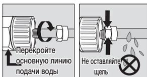
4. После подключения линии подачи воды к фильтру очистки воды включите источник водопроводной воды и слейте примерно 3 л воды, чтобы прочистить фильтр очистки воды и подготовить его к эксплуатации.
