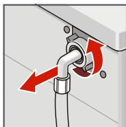
Снимите шланг со спинки прибора.
