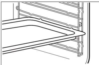
Одновременная установка решетки и глубокого противня:
