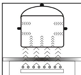
Электрический генератор питает катушку, расположенную внутри оборудования. Данная катушка создаёт магнитное поле и в момент размещения на плите кастрюли к ней (кастрюле) проникает индукционный ток.
