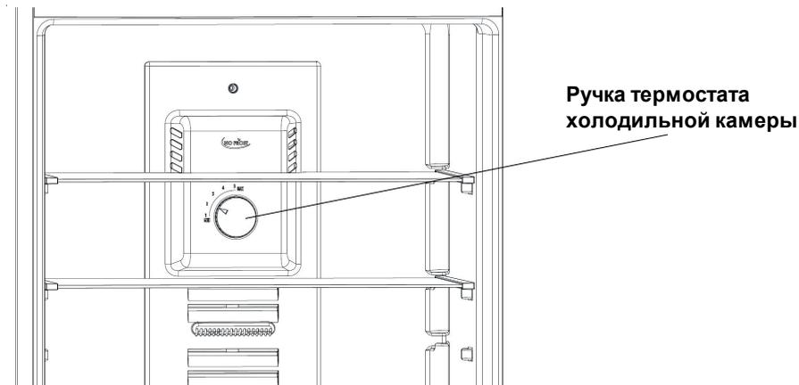
С ее помощью осуществляется автоматическая настройка температуры холодильного отделения устройства. Возможна установка параметров от 1 до 5.
