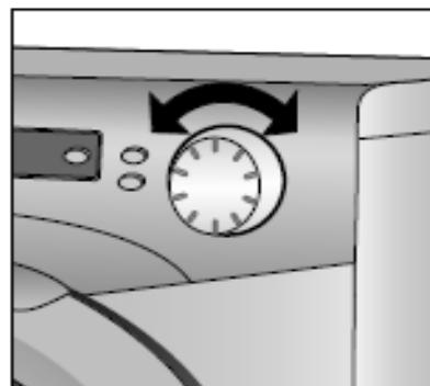
Для того чтобы выключить машину, установите переключатель программ в положение "Выкл."
