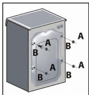
**Примечание.** Рекомендуем сохранить элементы транспортного крепления, чтобы использовать их в случае возможной будущей транспортировки. Производитель не несет ответственности за любые возможные повреждения машины по причине невыполнения правил, касающихся транспортного крепежа. Установка машины производится за счет ее владельца.
