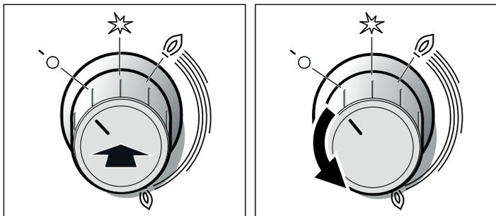
Активируется система защиты от утечки газа. Благодаря этой системе, при внезапно погасшем пламени автоматически прекращается подача газа.
