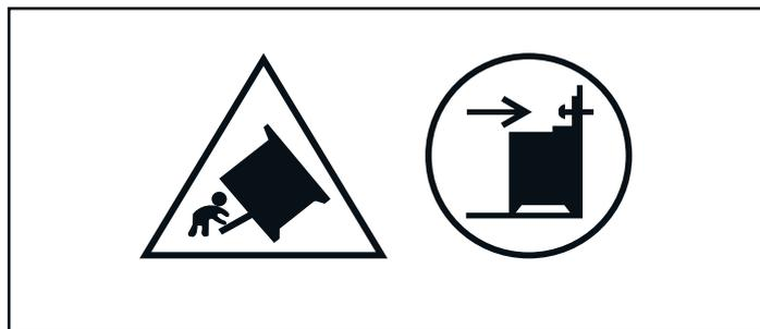
**Предупреждение:** Чтобы прибор не опрокинулся, нужно установить специальную защиту. См. инструкции по монтажу.
