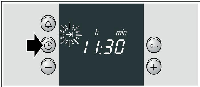
6. Вы можете установить более позднее время окончания с помощью кнопки **+**. Через несколько секунд установка автоматически принимается. Время окончания будет отображаться на дисплее, пока духовой шкаф не начнет работать.
