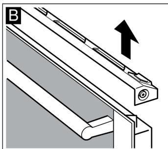
Проследите за тем, чтобы выдвигная часть духового шкафа не закрылась, пока панель будет снята. Наружное стекло может быть повреждено.
