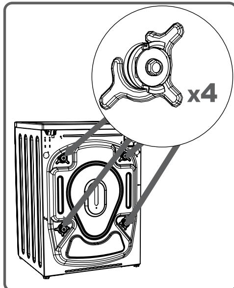
Поэтому необходимо удалить транспортировочные винты, открутив их против часовой стрелки при помощи соответствующего гаечного ключа.
